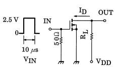
$$\begin{split} &V_{DD}=3~V\\ &D.U. \le 1\%\\ &V_{IN}:t_r,~t_f < 5~ns\\ &(Z_{out}=50~\Omega)\\ &COMMON~SOURCE\\ &Ta=25^{\circ}C \end{split}$$
